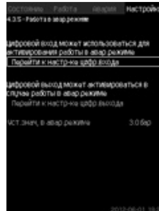
Рис. 32 Работа в аварийном режиме
